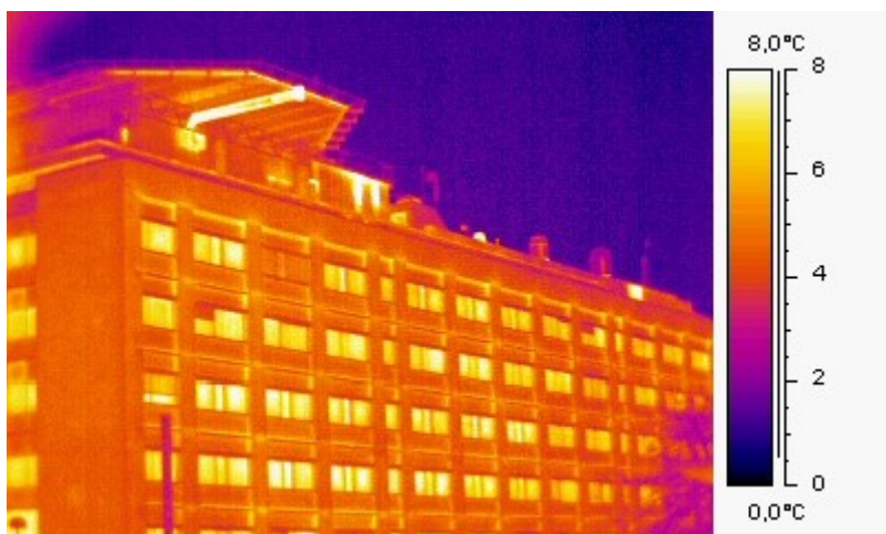
Bilde nr. 2. Hva skjuler seg under Picasso-tegningen på gavlveggen av Y-blokka? Jo, en rekke kuldebroer som leder varme ut i veggene fra etasjeskillene. Slike fasader burde egentlig etterisolerers, selv om Picasso-tegningen i så fall blir skjult for publikum.
