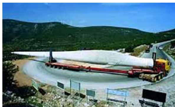
Svære veianlegg gjennomskjærer et vindindustriområde. Bare å få fram en møllevinge krever breie veier og digert utstyr. Fra infobasen "Fornybar.no".
