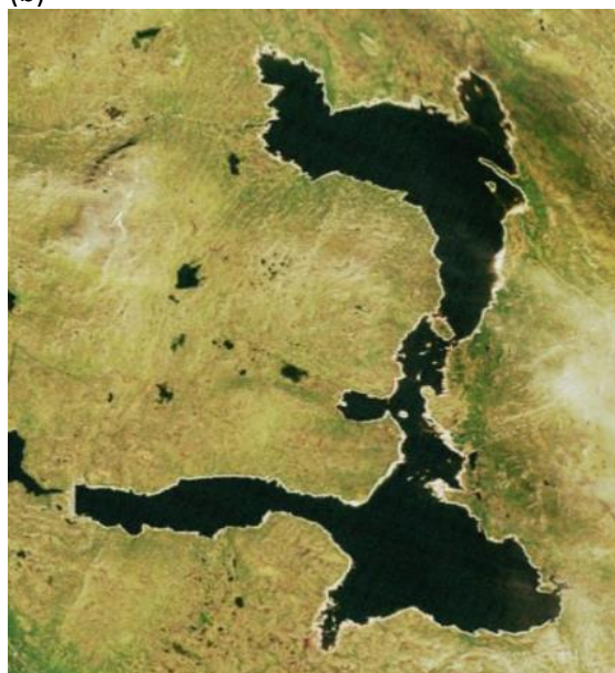
Figur 2. Nesjøen er et kunstig reguleringsmagasin i Trøndelag som ble oppdemmet for vannkraft i 1971. Figuren viser Nesjøen (a) før oppdemming, (b) etter oppdemming og (c) overlagt Trondheim by. Store våtmarksarealer, kalt Neamyrene, ble lagt under vann. Bilder og kart fra Martin Dörber / NTNU.
