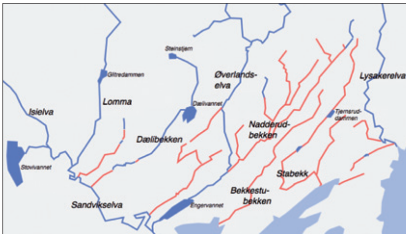
«Bekkene i Bærum som ble borte», NiB 2000. Dette er et forenklet kart som viser hovedvassdragene. Blå farge er levende vassdrag, rød farge er lukkede og nedgravde vassdrag.
