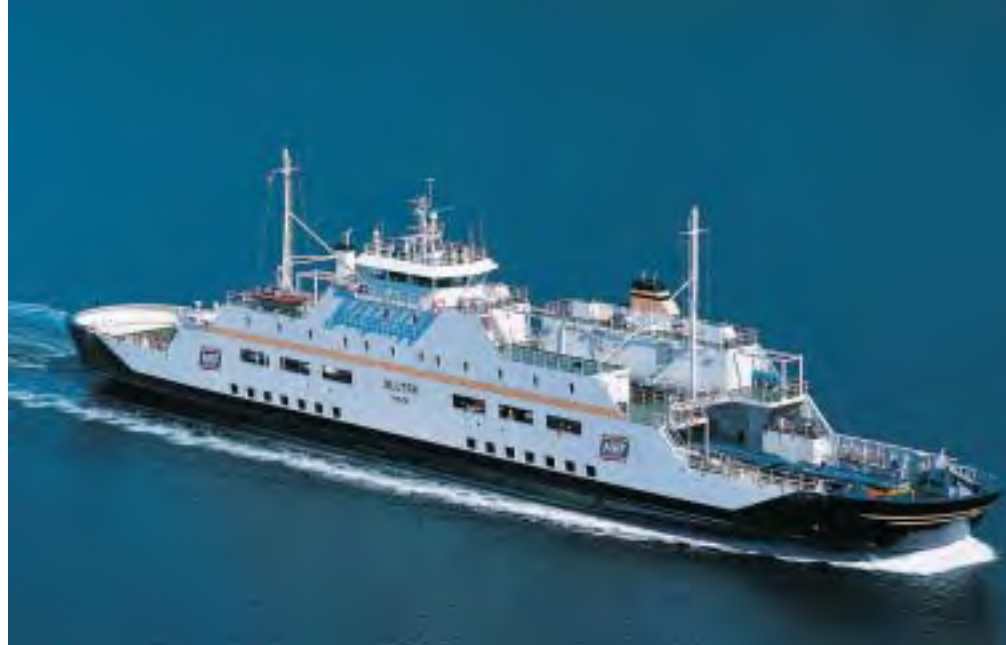
Den gassdrevne ferjen Glutra går i skytteltrafikk i Møre og Romsdal. Hun slipper ut 75 – 90 prosent mindre NOx enn andre ferjer på tilsvarende størrelse. (Foto: MRF)
