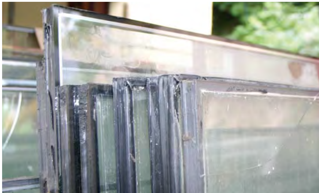
Disse PCB-holdige isolerglassrutene befinner seg der de helst skal være: På et godkjent behandlingsanlegg. Anslagsvis 96 prosent av alle slike vinduer samles nå inn. (Foto: Kristian S. Aas)
