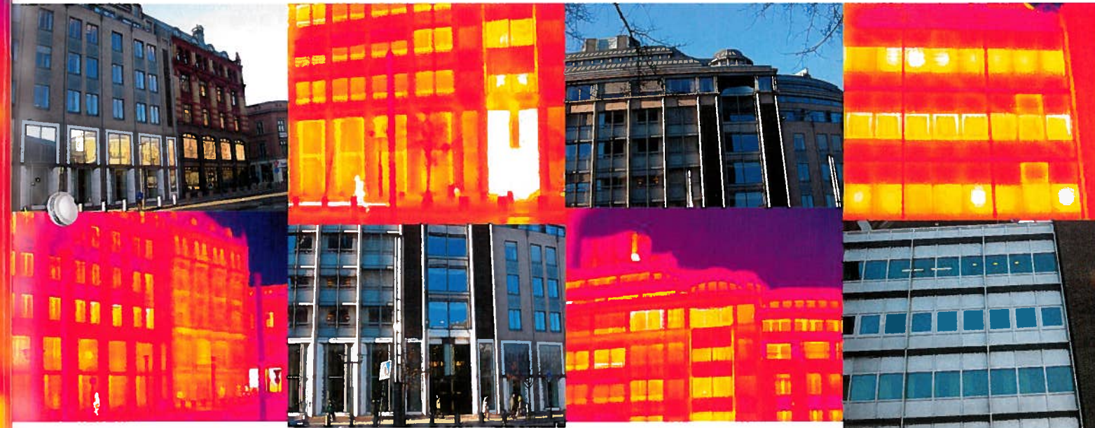
Gammelt og nytt departementsbygg. – Bildet viser tydelig at bygget til venstre er mye bedre isolert enn det til høyre, sier sivilingeniør Morten Lian i Byggforsk.
