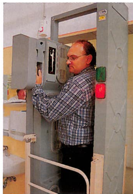
Arbeider som blir scannet for stråling på vei ut av anlegget.
