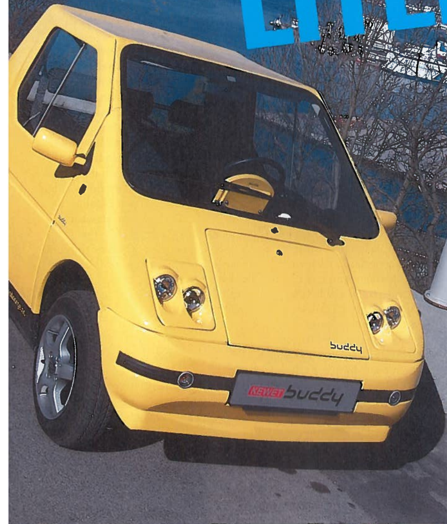
Buddyen er en typisk bybil: Innkjørt skal batteriene klare fem til åtte mil mellom hver lading.
