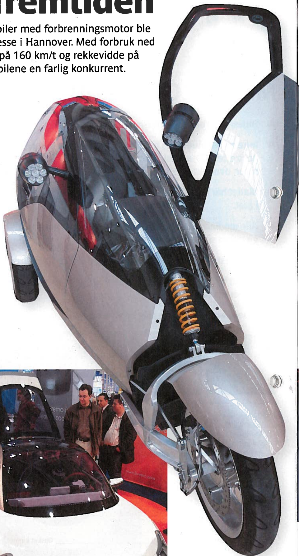
Trehjulingen Clever går på naturgass, har en toppfart på 80–100 km/t og kan kjøre 100 kilometer på 2 kilo naturgass, noe som tilsvarer 2,5 liter bensin.
