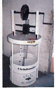
Cesta bygger også macate – vannpumper. Her en demonstrasjonsmodell på økosenteret.
