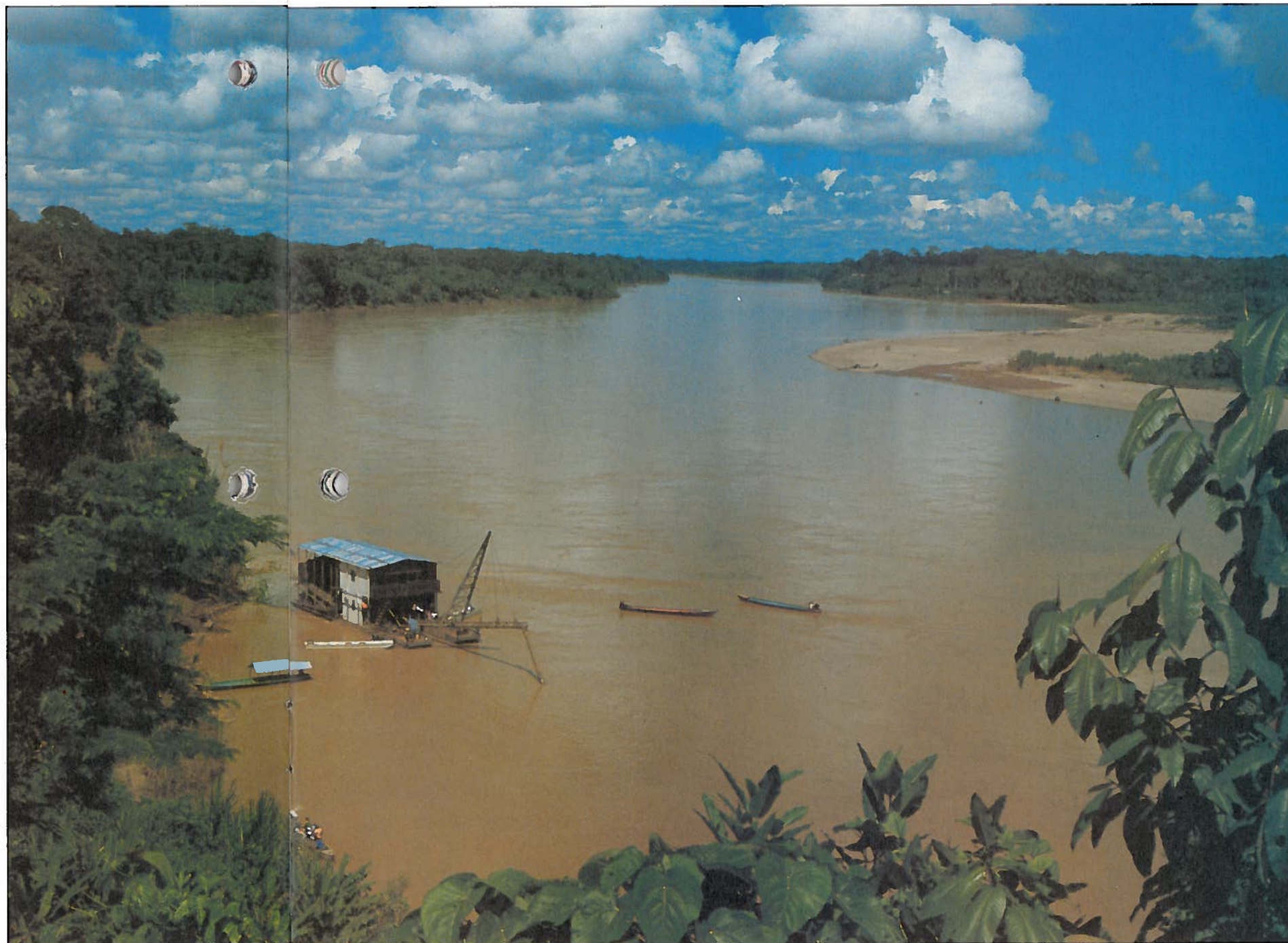
GULL OG GRØNNE SKOGER: Mye av gullutvinningen i Amazonas skjer fra flåter der bunnslammet pumpes opp og vaskes rent for gull.
