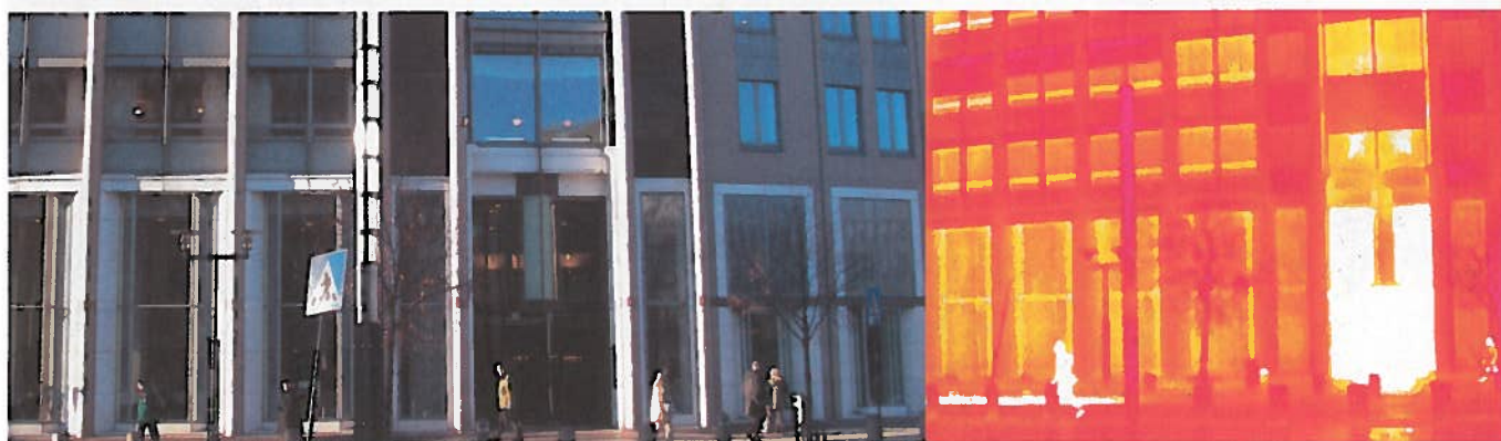
De lyse feltene i bildene til venstre viser at energi lekker fra inngangsparti og tak. — På taket mangler varmeveksler for å håndtere energien. Her renner skattepengene ut, sier generalsekretær Tore Killingland i Naturvernforbundet.
