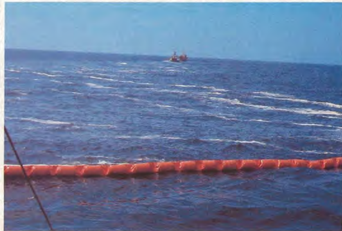
Fig. 5. Oljeemulsjonen gjekk også under sikringslensa som var utlånt frå Statens forurensningstilsyn. I søknaden frå PFO var denne lensa beskrevet som ein garanti mot oljeutslipp under prøvene sommaren 1980.
