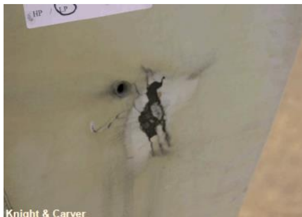
Figur 26 Skade på turbinblad etter lynnedslag. Frå den britiske rapporten
