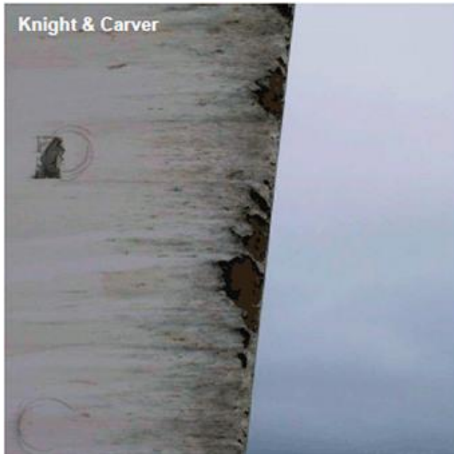
Figur 27 Slitasje på turbinblad. Frå britisk vurdering av risiko 68
