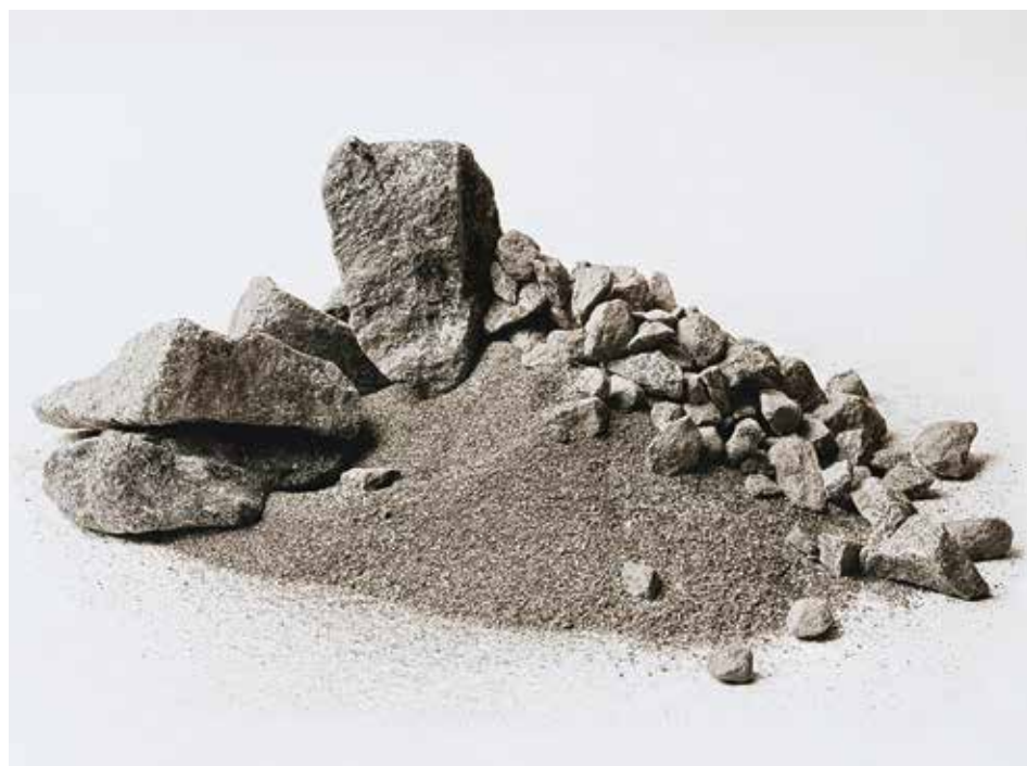
Selskapet SafeRock skal lage betong ved hjelp av gruveavfall. Bildet viser avgangsmassen og bergarten noritt fra gruveselskapet Titania.
