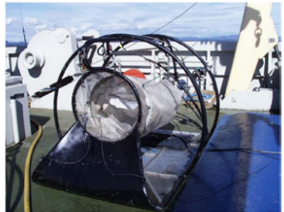
Figur 2. Prøvetaking av reker tas med en bunnslede (Beyersleden) som rekkes over bunn i en distanse av ca. 1 km.
