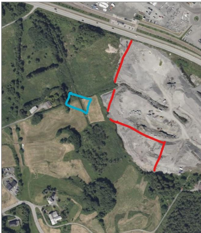
Figur 1. Røde streker angir utfylling av masser som har gått utover 2019-dispensasjonen (utgjør omtrent 10 dekar). Ufyllingen går ikke utover regulert område, men skjedde før reguleringsplanen ble vedtatt. Lyseblå firkant angir hvor broa over grøntstruktur/elvepark (Storeveita) er vist i reguleringsplanen (Storeveita er planlagt lagt om i dette området). Den økologiske korridoren (viltkorridoren) vil her være på sitt smaleste der broa er vist (broa er omtrent 30 meter lang og 20 meter bred) – og korridoren vil i tillegg altså gå under en stor bro, med de konsekvenser det får for vegetasjon, insekter osv. Flyfoto: Statens kartverk / Norgeskart.no.
