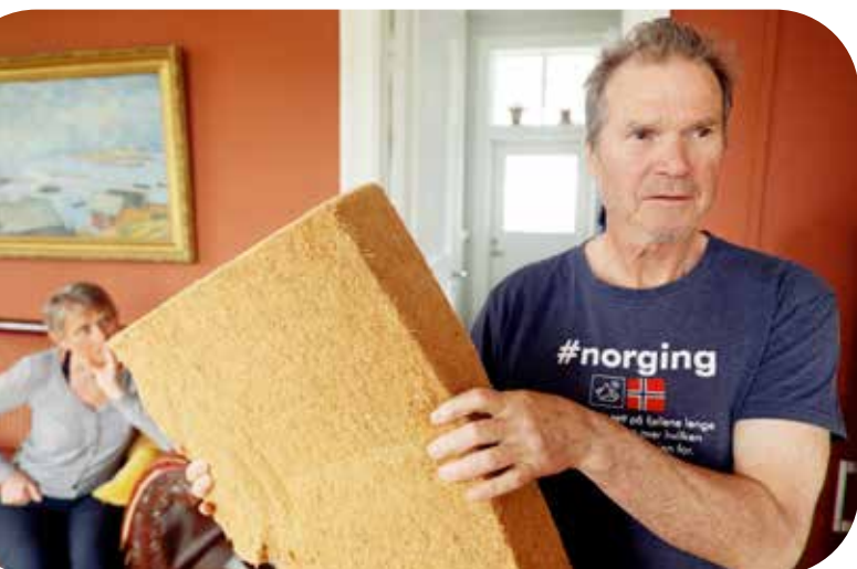
Etterisolering med trefiber. Foto: Sveinung Sundfør Sivertsen
