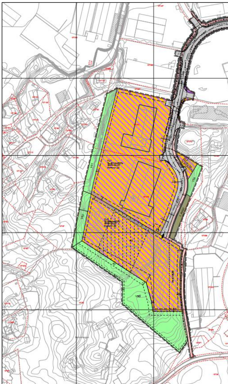
Fig. 3. Plankart Smalhusaugen næringsområde. Grønt er planlagt steinfyllinger med etterfølgende etablering av vegetasjon. Kart: Tiltakshaver.
