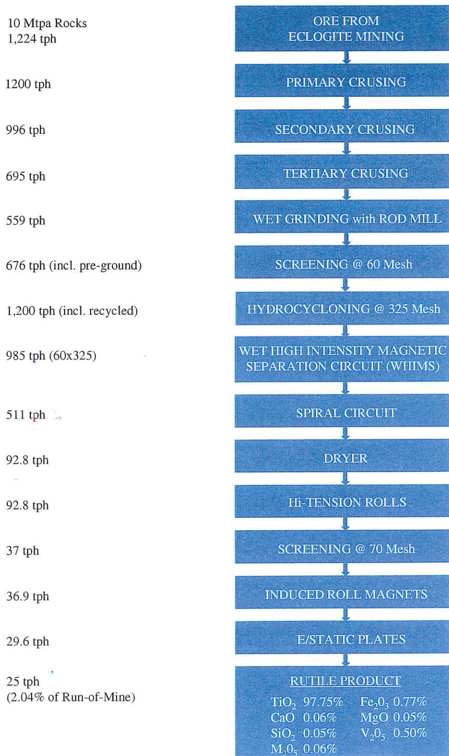
Fig. 23. Process flowsheet for Engebøfjellet eclogite
