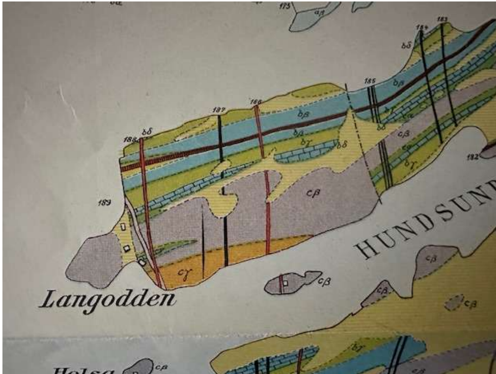
Utsnitt av geologisk kart over Fornebu og Snarøya med kalkstein i blå farge (og i lysebrunt).
