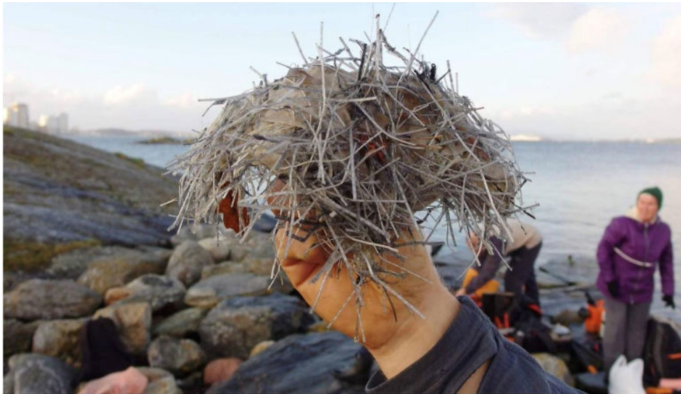
Armeringsfiber i plast som følger med stein fra tunellprosjekt. Foto NRK
