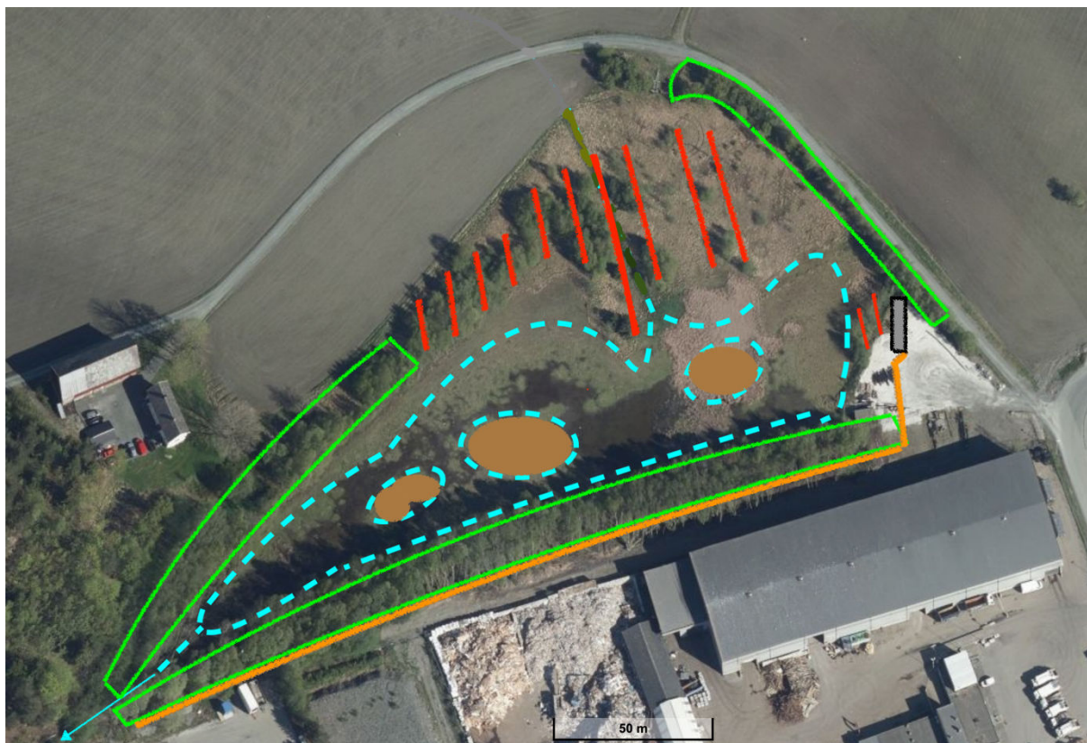
Figur 2. Illustrasjon av aktuelle tiltak. Grønne linjer - eksisterende trær som bevares som skjerming. Rød streking – fjerning av trær og større busker. Blå stiplet linje – område for oppgraving av vegetasjon og åpning av vannspeil. Blå pil - utløp av bekk. Brune felt – etablering av holmer for hekkende/rastende fugl. Oransj linje – skjerming(jordvoll/vegg) mot planlagt gang- og sykkelvei og parkering. Grått felt m svart ramme –sandsvalebygg.
