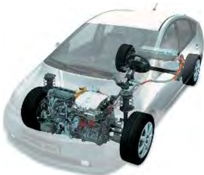
Toyota Prius har en elektrisk- og en bensinmotor som arbeider sammen for optimal utbytte av energien. Resultatet er ett tonn reduserte CO 2 utslipp per år, per bil. (Illustrasjon: Toyota)
